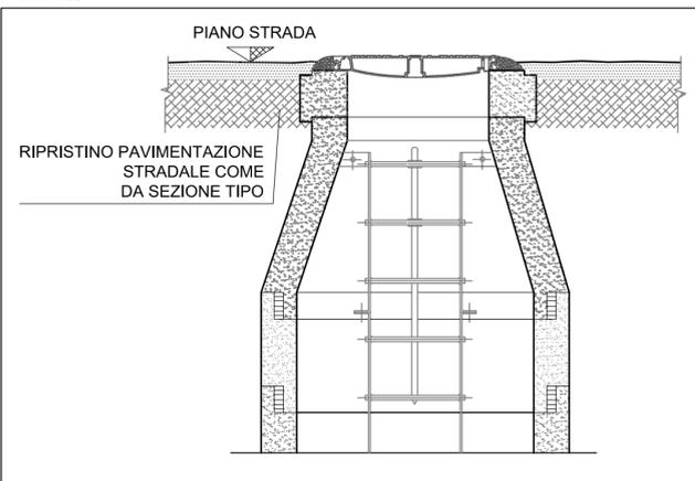
SEZIONI PROGETTO - POZZETTI DI RACCORDO FOGNATURA
